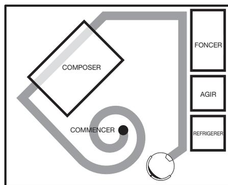
Scooba alternera ses programmes entre le nettoyage en spirale, en suivant le mur et en traversant la pièce au cours d'un même cycle de nettoyage.
