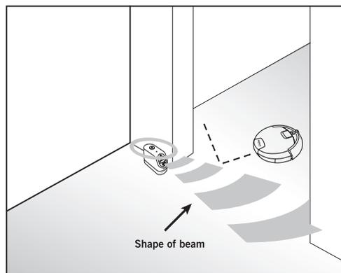
Les Virtual Wall nécessitent 2 batteries « D ». Ils s'éteignent automatiquement à la fin de chaque cycle de nettoyage.
